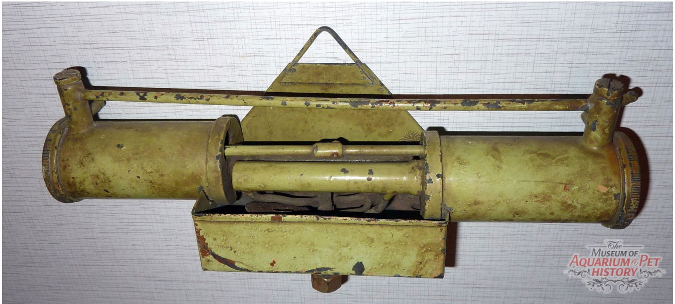
Luftpumpe deutscher Produktion aus den 20er-Jahren
