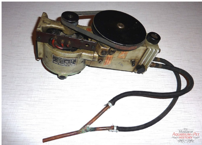
Membranpumpe aus der ersten Hälfte des vorigen Jahrhunderts
