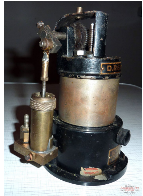
220 Volt Elektropumpe, die aquaristisch zum Einsatz kam
