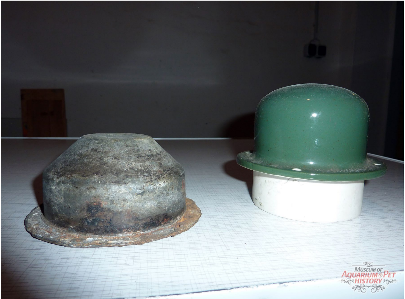
Heizkegel, die unter dem Aquarium positioniert wurden
