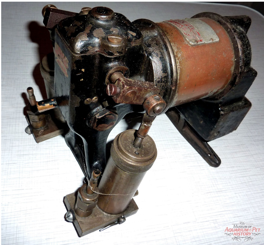
220 Volt Elektropumpe, die aquaristisch zum Einsatz kam
